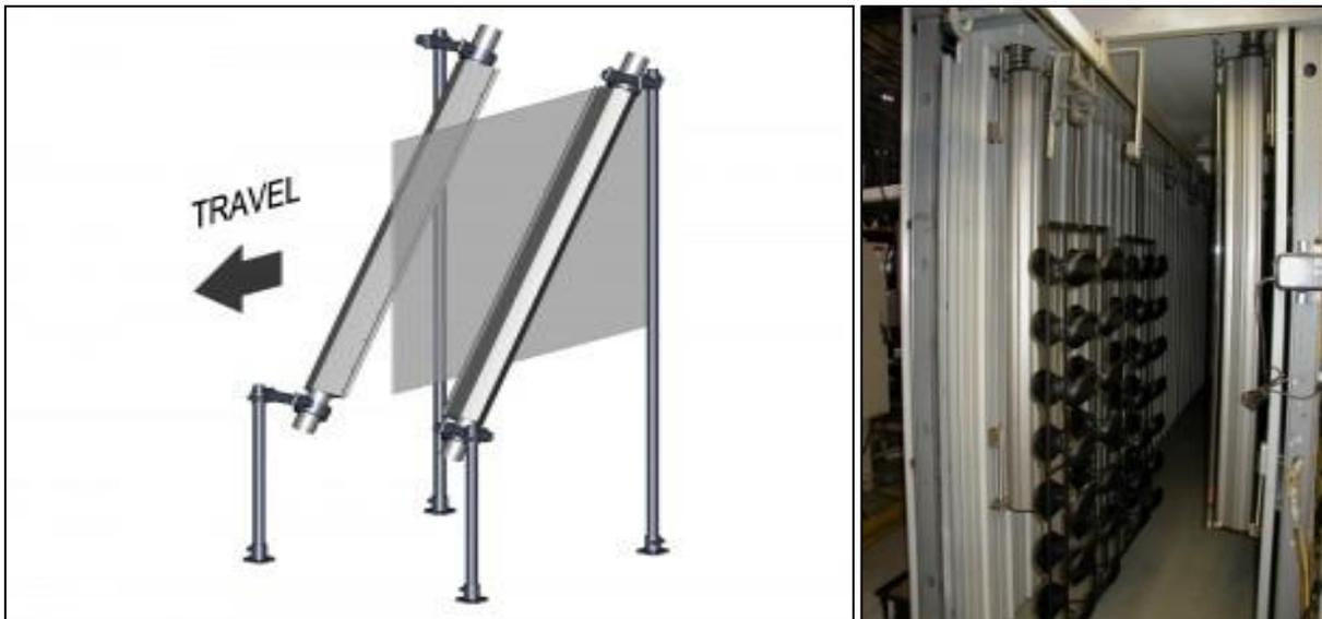
图片是一个典型的悬挂零部件连续输送的除水干燥方案。而悬挂的产品可以是汽车零部件，也可以是五金件，PCB 电路板，而图片上是一个平板玻璃输送干燥。
